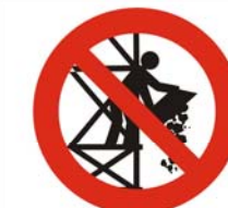
VIETATO GETTARE MATERIALI DAI PONTEGGI
