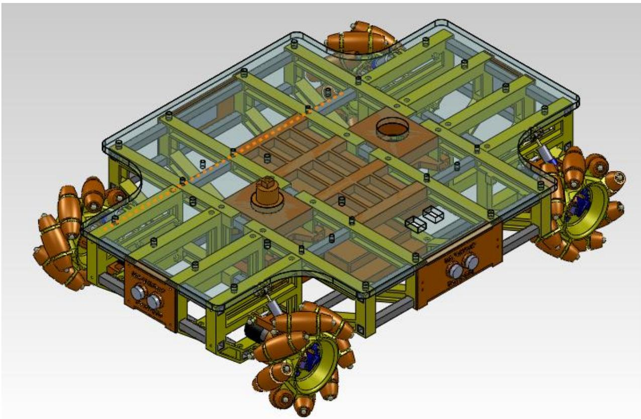
La particolarità della piattaforma consiste nelle quattro ruote motrici indipendenti omnidirezionali. Si tratta di ruote a rulli doppio conici a  $45^\circ$  montati sulla periferia di un cerchione, seguendo il profilo di un'elica cilindrica (due destrorse e due sinistrorse). Per la corretta movimentazione è necessario che le due eliche destrorse siano diagonalmente opposte alle due eliche sinistrorse.
